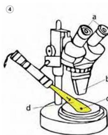
Fig. 4 Loupe binoculaire (= stéréo-microscope); a: oculaires, b: objectif double, c: préparation, d: éclairage par dessus; Abb. 4 Binokular (=Stereolupe); a: Okular, b: Objektive, c: Präparat, d: Belichtung von oben
